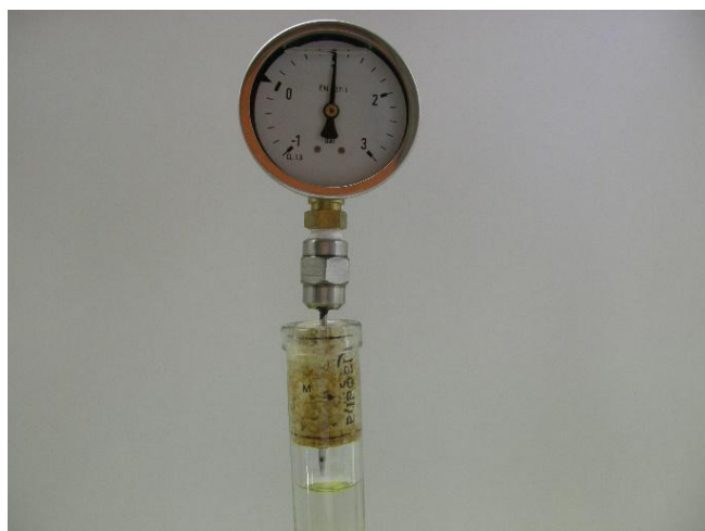
Sobrepresión en el encorchado.
